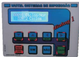
Comando eletrônico com display alfanumérico e teclado, facilitando a operação e o aprendizado.
